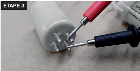
3. En utilisant un ohmmètre, placez 1 sonde sur l'une des 4 broches et en détectant les 3 broches restantes l'une doit avoir de la continuité. Assurez-vous que les broches restantes ont également de la continuité. Lorsque les 2 jeux de broches testent la continuité, on suppose généralement que la lampe est bonne.
