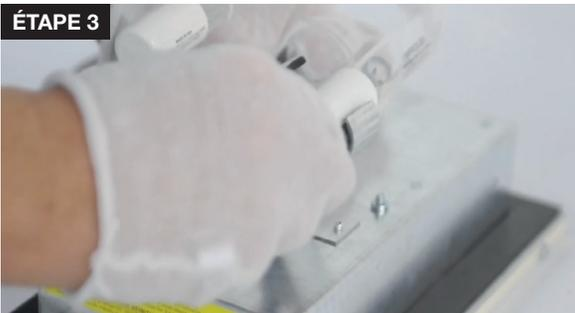
3. Retirez l'ancienne lampe UV en ouvrant la pince de retenue et en tirant la lampe hors de la chambre du réflecteur.
