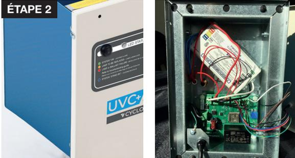
2. Placez le UVC+ AIR face vers le bas sur une surface plate et retirez les 4 vis (2 en haut et 2 en bas) qui attachent le couvercle à la boîte de ballast.
