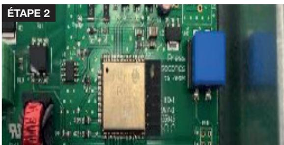
2. Branchez le UVC+ AIR à une source d'alimentation et allumez l'appareil en appuyant sur l'interrupteur. Dans les 5 premières secondes après l'allumage, appuyez une fois sur le bouton Reset. En faisant cela, vous verrez que la lumière DEL devient Bleue, ce qui signifie que la détection du flux d'air est activée. En appuyant encore une fois, en dedans de 5 secondes, la lumière DEL deviendra Blanche, ce qui signifie que la détection du flux d'air est désactivée.
